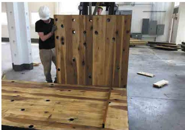
Com a pesquisa começando na escala de uma amostra de laboratório, o resultado se deu em painéis de alta resistência, medindo 1,5 m por 3 m. Com eles, a equipe de alunos e professores foi capaz de incorporar características arquitetônicas únicas no projeto que se alinhava com as robustas métricas de desempenho do HCLT, incluindo balanços estruturais de 7 centímetros de espessura e membros estruturais expostos.
