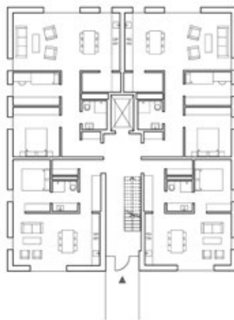
Plan 1. De to mindre blokkene mot nord har samme fotavtrykk, med fire leiligheter i 1. etasje og to i de øvrige etasjene. Den større blokken mot sør er mer kompleks med seks til åtte enheter per etasje pluss kafé på hjørnet
