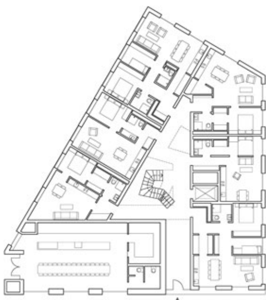
Plan 1. De to mindre blokkene mot nord har samme fotavtrykk, med fire leiligheter i 1. etasje og to i de øvrige etasjene. Den større blokken mot sør er mer kompleks med seks til åtte enheter per etasje pluss kafé på hjørnet
